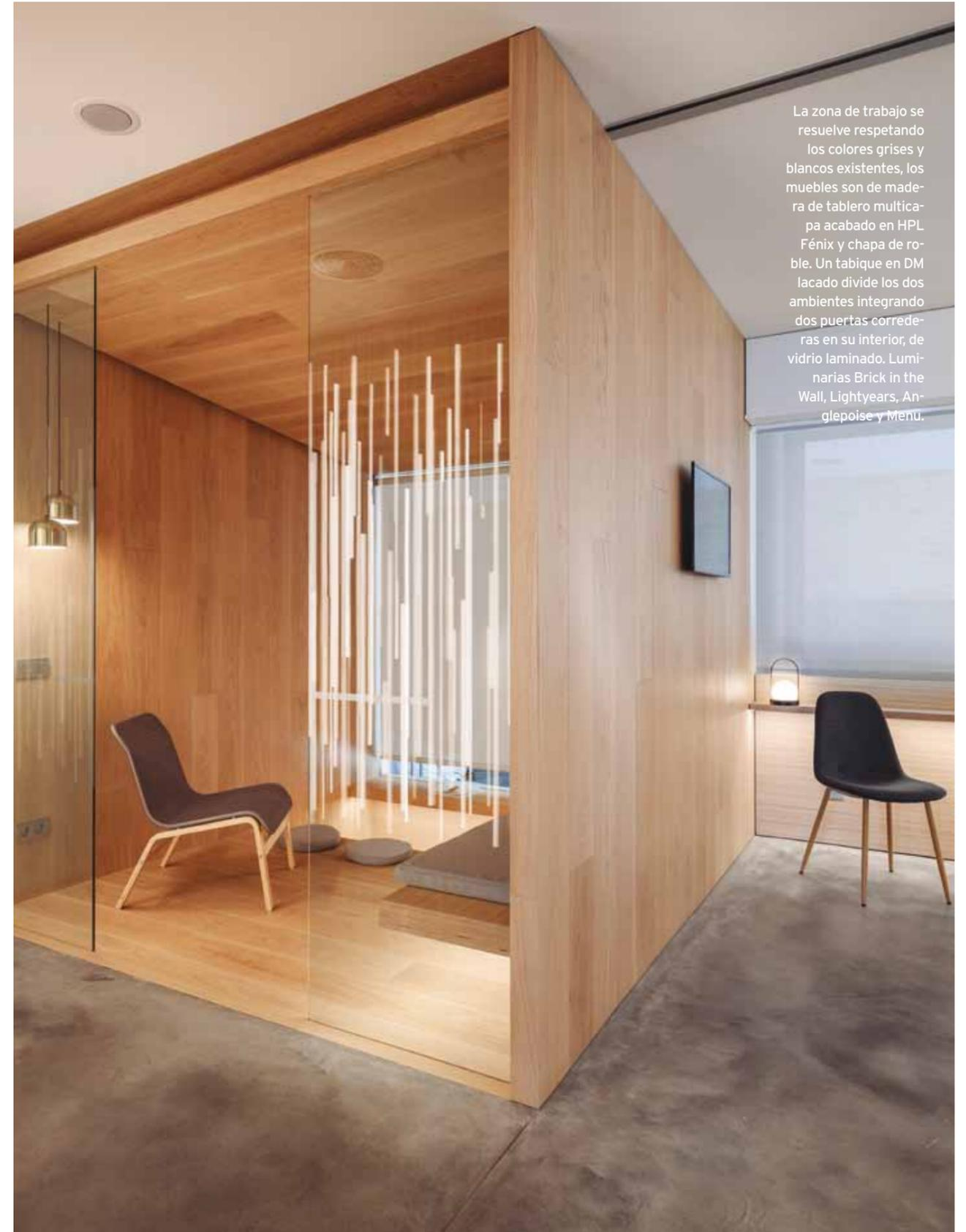
La zona de trabajo se resuelve respetando los colores grises y blancos existentes, los muebles son de madera de tablero multicapa acabado en HPL Fénix y chapa de roble. Un tabique en DM lacado divide los dos ambientes integrando dos puertas correderas en su interior, de vidrio laminado. Luminarias Brick in the Wall, Lightyears, Anglepoise y Menu.
